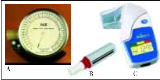
FIGURA 2. LE TRE GENERAZIONI DI MISURATORI DI PICCO DI FLUSSO. A-WRIGHT PEAK FLOW METER (1959); B-MINI-WRIGHT PEAK FLOW METER (1978); C-PIKO-1 (2003)
